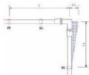
Roztažnost trubek při změně směru. Dilatační rameno se zjistí výpočtem nebo z grafu.
